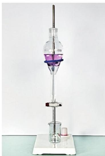
> Une ampoule à décanter permet de séparer deux liquides non miscibles.
