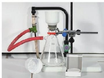
> Lorsque l'eau circule, une aspiration dans la fiole à vide est créée grâce à la trompe à eau.
