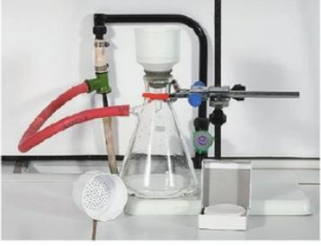
> Lorsque l'eau circule, une aspiration dans la fiole à vide est créée grâce à la trompe à eau.
